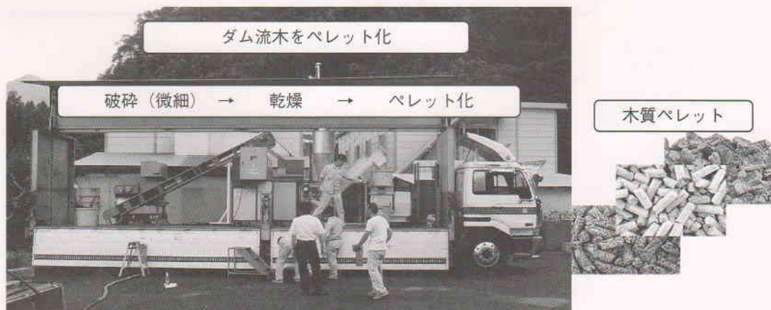
車載型ペレット製造器による実証状況
