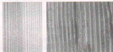
写真 徳島すぎの柾目と細胞断面 (繊維方向) (徳島森林研 仁木 2001)
