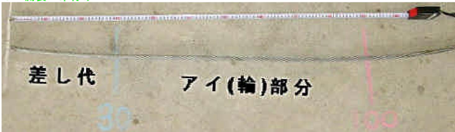
直径10mm程度のワイヤーロープの場合、差し代（細工代）は30cm、アイ（輪）部分の長さは70cm、合計1m程度が適当です。それぞれの位置にチョークなどで印を付けましょう。
