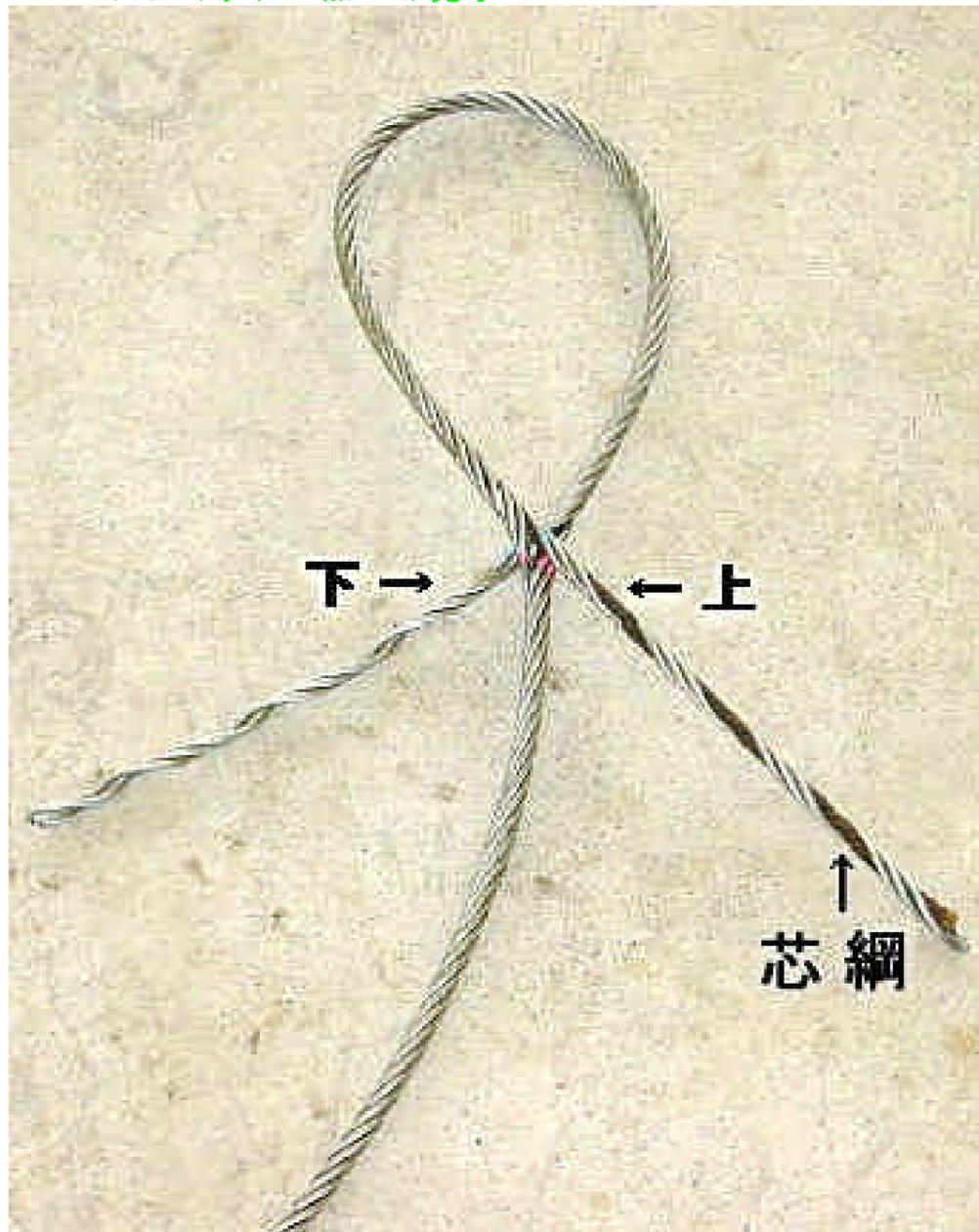
アイ（輪）の部分をよく観察し、形崩れしたり、隙間から芯網が見えていたらやり直し。
