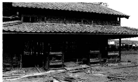
土壁を取り除き実験開始 (横から引っ張る)
