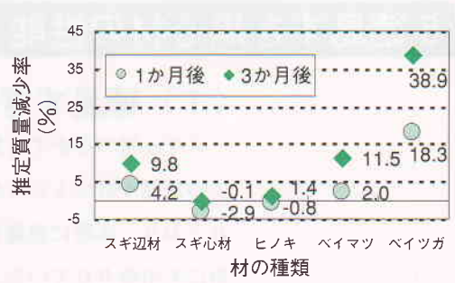
図3 含水率15%と仮定したときの推定質量減少率
