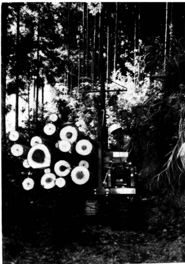
③ 実車走行 見通しを良くするためバックで走行
