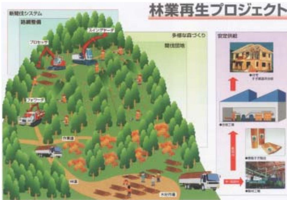
幅 2 m の作業道で高性能林業機械 3 点セット (スイングヤーダ、プロセッサ、フォワーダ) を利用し、生産性を飛躍的に高めます。
