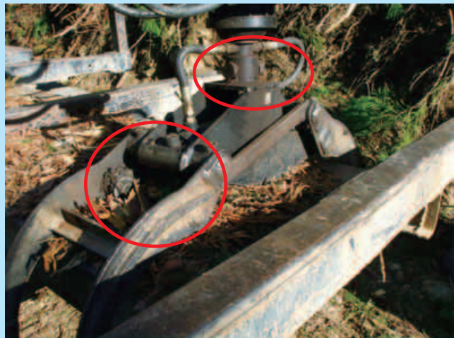
写真一九 補強溶接
