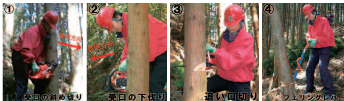
写真-1 伐倒作業の手順
