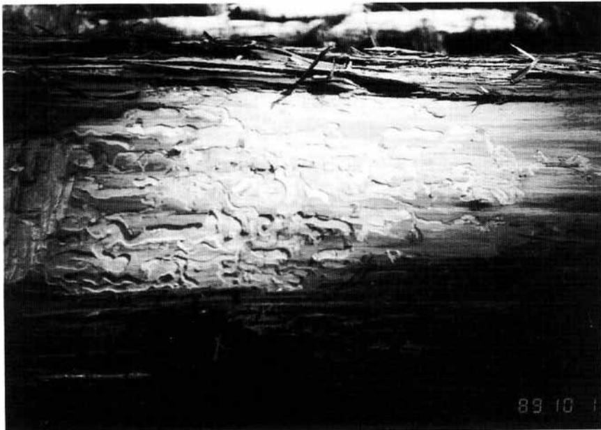
写真-15 ヒメスギカミキリの被害材
