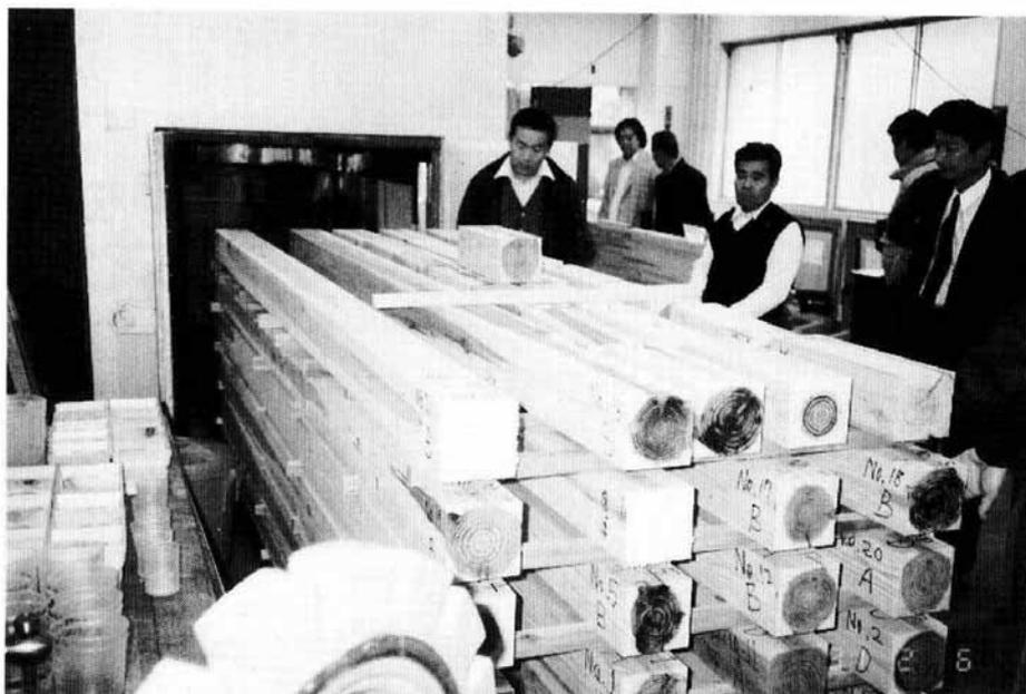
写真－５ スギ柱角の人工乾燥試験（林業総合技術センター）
