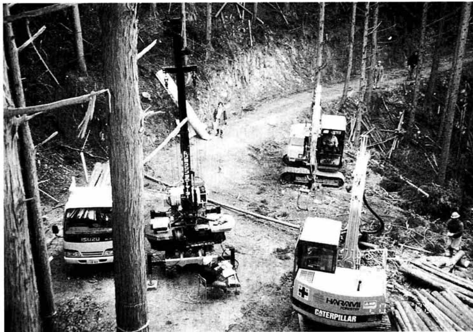
タワーヤード (中) とハーベスター (右手前) とグラップル (右後方)
