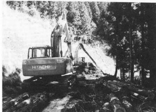
スイングヤーダとプロセッサによる作業状況
