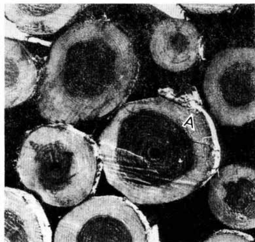
▲ 目まわりと材面割れでよくない丸太(A部分)
