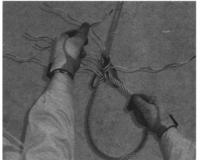
シノの溝に5本目のストランドを差し込む。
