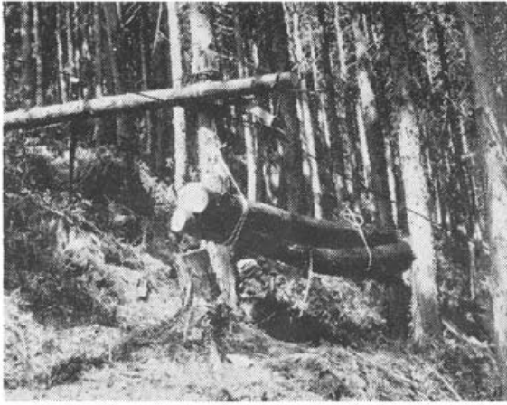
単線循環式架線による運材
