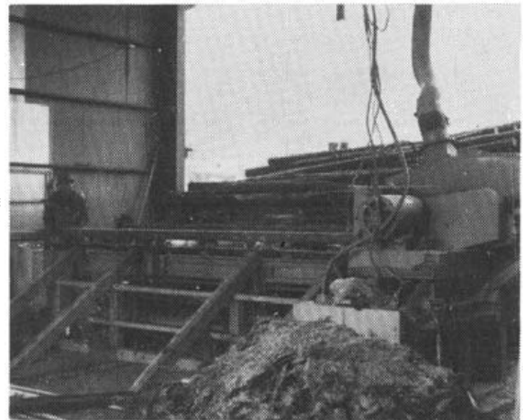
スケヤリング両面取機 美馬町村雲製材
