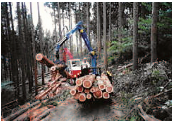
フォワーダ (生産された木材をトラック道まで運搬する)
