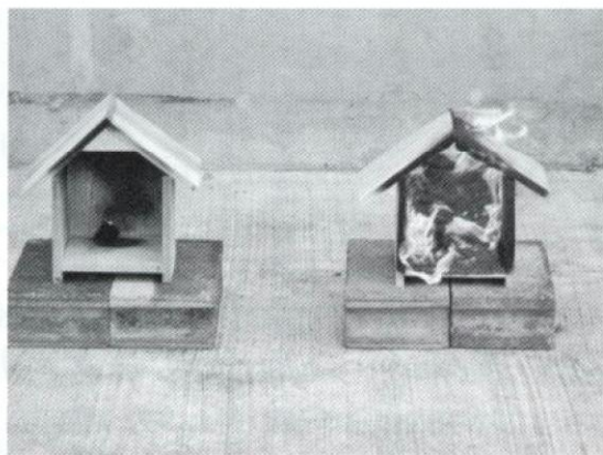
準不燃木材燃焼試験（左は処理材、右は未処理材）
