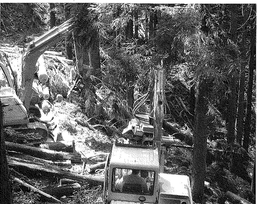
の二一%を占める作業中断時間のうち、五分の三が根株への材の引っ掛けによるものであることから、根株の処理方法、あるいは集材線の張り高を工夫する必要があるようです。（森林林業研究所の調査から）
