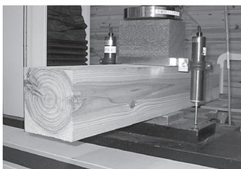
写真-3 材中間部のむりこみ試験
