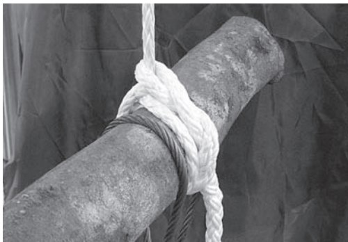
写真-2 繊維ロープの結び留め強度試験
