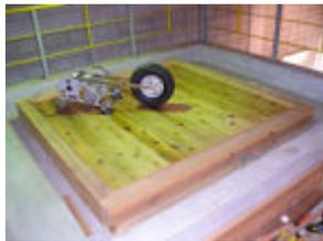
写真 - 3 軽量床衝撃音測定 写真 - 4 重量床衝撃音測定
