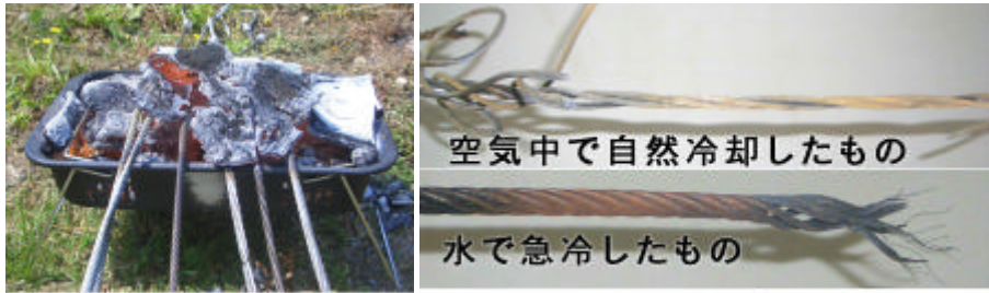
(写真④) 各試験体の加熱状況 (写真⑤) 引っ張り破断したワイヤ (表④) 加熱・冷却と強度変化
