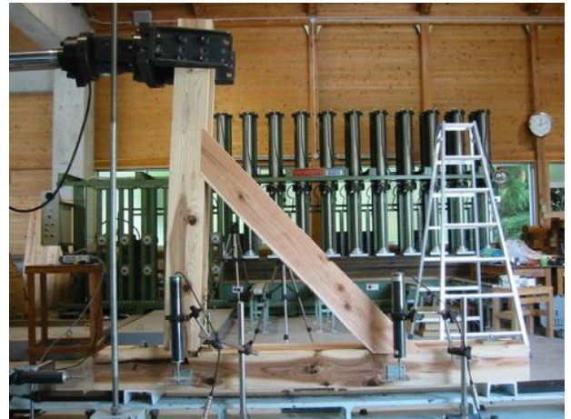
図-6 大入れ引き寄せボルト火打ち材の試験状況
