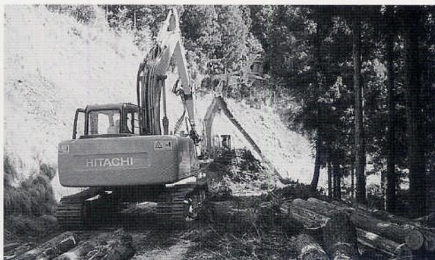
スイングヤーダとプロセッサによる作業状況
