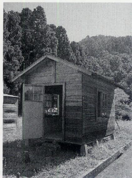
ところが、合板の上にスギ板を全面に貼った場合、午前9時には検出されず、午後1時には0.07ppm、午後5時には0.08ppmと微増したものの、午後9時には0.06ppmと微減し、厚生省の定める指針値0.08ppmをクリアしました。午後5時の時点で、合板からのホルムアルデヒド放散量を81%抑制したことになります。
