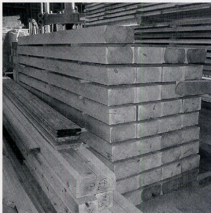
写真1 実験棟内での人工乾燥材のシーズニング
