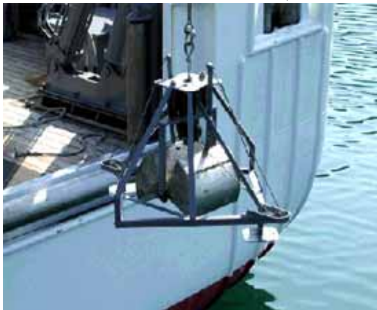
写真1 スミスマッキンタイヤ型採泥器(採泥面積 1/4 \text{ m}^2 )。総重量 42.5 kg、海底に着底すると同時に鋼鉄製のグローブがバネの力で閉まり、泥や砂及び小石まで採取することができる。
