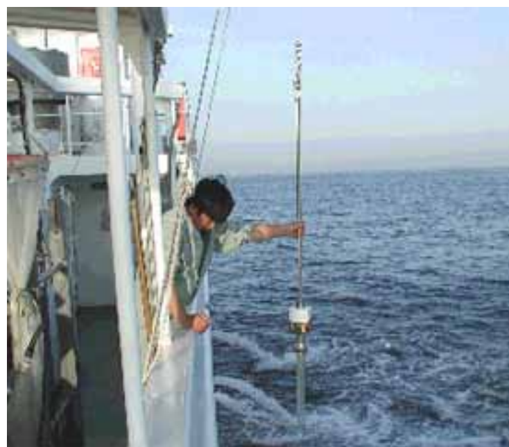
写真2 コアサンプラー採泥器(内径 36mm)。上部の錘りによる重力で海底の泥の中に突き刺さる。水深 30m 以浅の泥や粘土を採取することができる。
