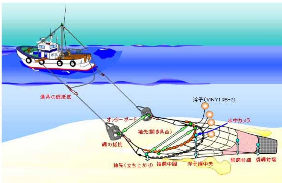
図 2. 小型底曳網の計測部位とカメラの装着位置。
