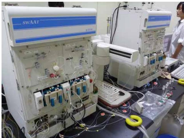
**写真 1. 栄養塩連続流れ分析装置。** 中央のトレイに濾過処理した海水検体を並べておくと, 自動的に吸い上げ栄養塩濃度を分析してくれる。1 検体の分析は約 90 秒で終わる。ただし, 稼働前に分析試薬調整や装置内部の洗浄に約 2 時間, 稼働後に装置内部の洗浄と乾燥に約 1 時間の作業が必要。
