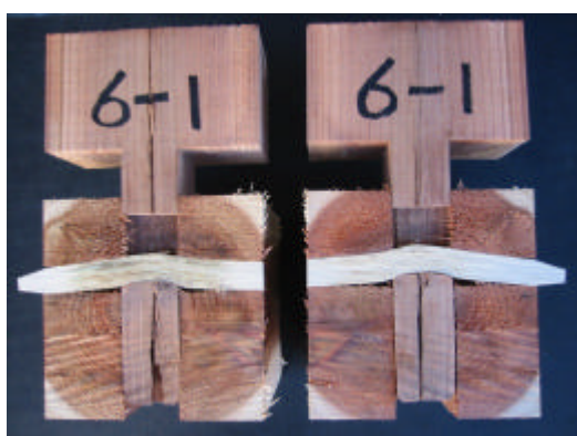
写真 - 3 ほぞのせん断破壊
