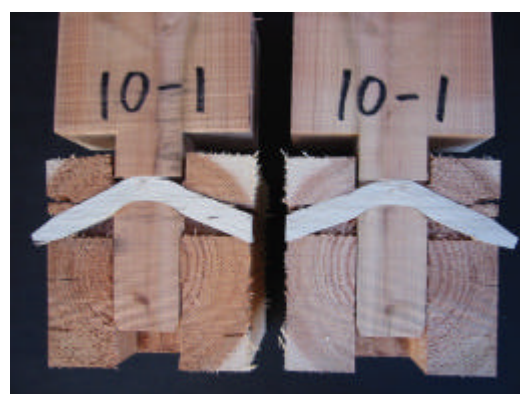
写真 - 4 土台の割裂破壊
