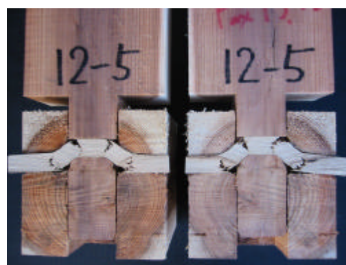
写真 - 2 込み栓のせん断破壊
