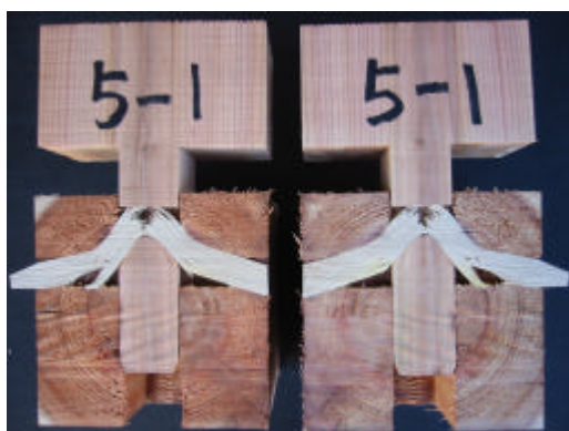
写真 - 1 込み栓の曲げ破壊
