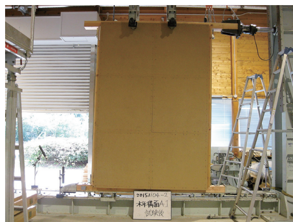
図2 面内せん断試験（右上が油圧ジャッキ）
