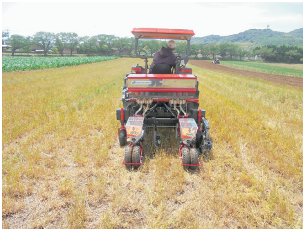
図1 試験に用いた不耕起対応播種機
