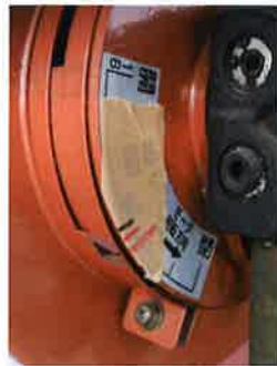
図1 エアーシャッターの開度 (黒線:調整前, 短赤線:空気調整後 長赤線:塗料塗布後空気調整)
