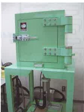
▲写真 ゲルマニウム半導体検出器 放射性セシウムの現行基準値
