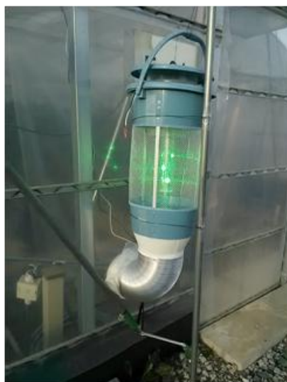
図2 益虫捕集装置及び益虫捕集方法
