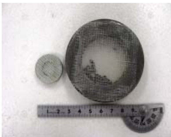
写真3 種子封入容器の形状の比較 (左：従来型，右：ワッシャーの形状を大きくした殻体)
