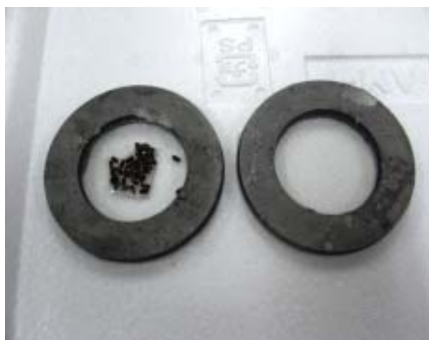
写真1. 使用した小型封入容器。ワッシャー中央部にアマモ種子を入れ、その上からメッシュ生地を接着させたワッシャーを重ね合わせる。
