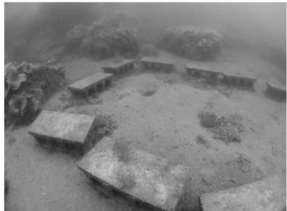
写真1. 建材ブロックの配置例（水深5.5m。撮影：6月26日）
