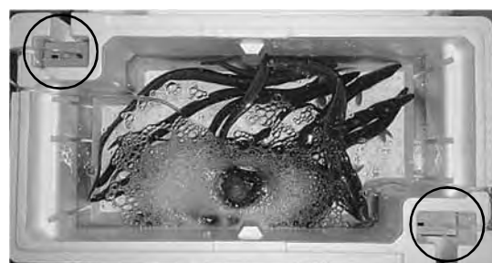
写真1. 発泡スチロール箱によるハモの生き残り試験 ○囲みが電池式エアポンプ
