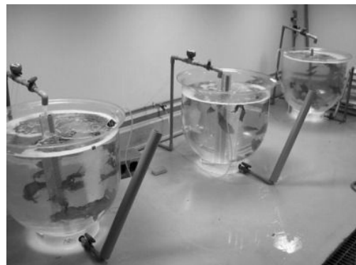
図3. 色落ちワカメの色回復試験。写真奥から止水区、かけ流し区及び施肥区
