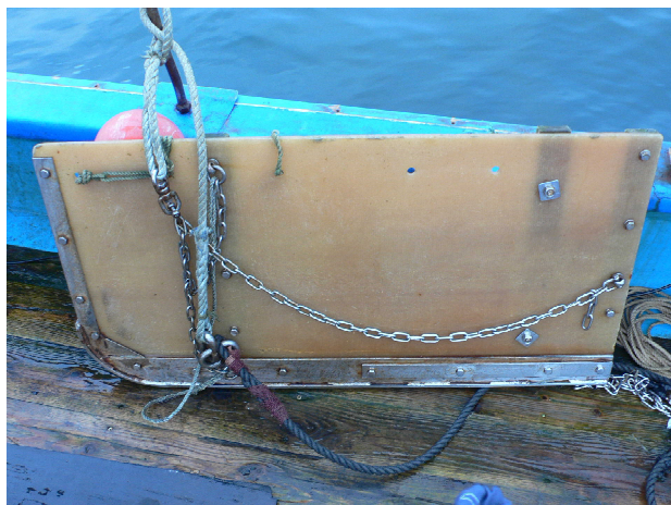
写真3. 横平板型開口板（縦60 cm×横120 cm、重量6 Kg/枚）。FRPの単板を木と金属で補強して作られる。ブライドルチェーンは3本、オッターペンメントチェーンは2本で、平板の前後左右の傾斜角度は糸目で調整される。
