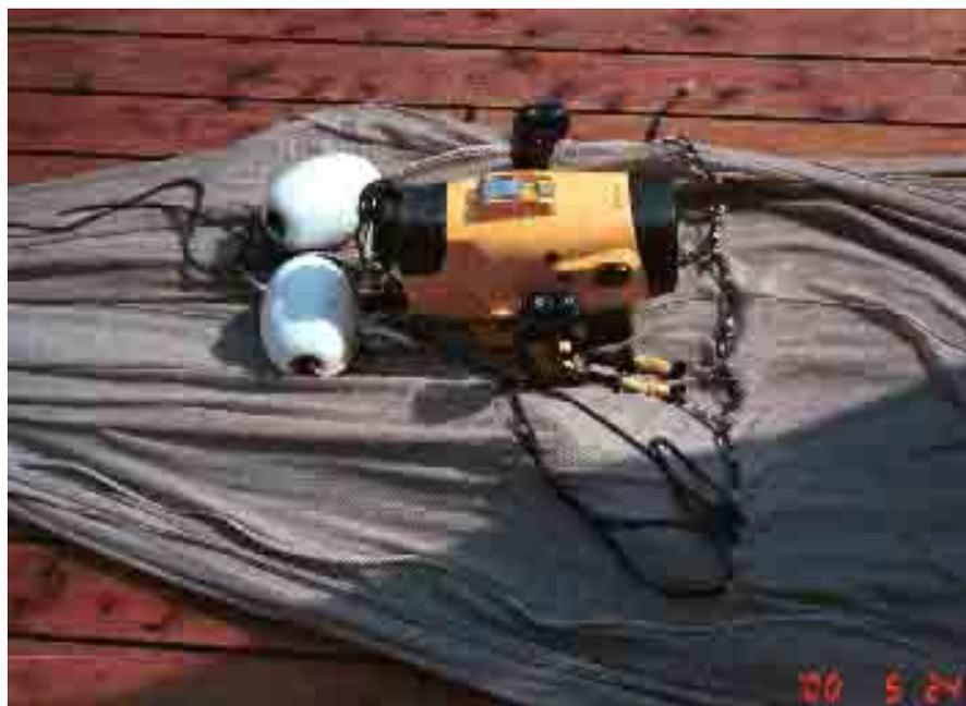
写真6 シラス観察に用いた水中カメラとその取り付け方法
