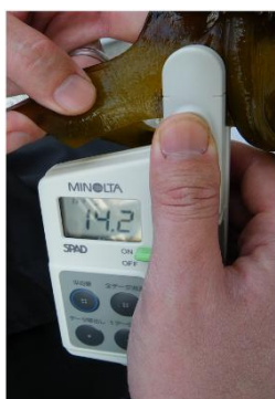
図1 葉緑素計を用いてワカメ藻体のSPAD値を計測
