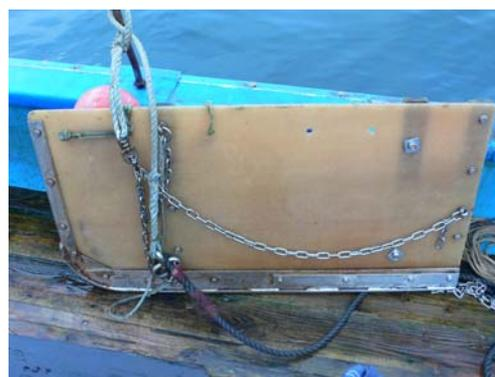
写真 2. 平板(縦 60 cm×横 120 cm, 重量 6 Kg/枚)。FRP の単板を木と金属で補強して作られる。ブライドルチェーンは 3 本、オッターペンネントチェーンは 2 本で、平板の前後左右の傾斜角度は糸目で調整される。
