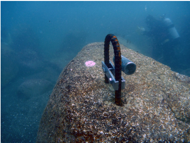
写真1. 志和岐地先の単体礁に取り付けた加速度ロガー計
