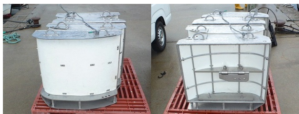
図1. FRP製HLTD (ニチモウ(株)製、1枚あたりの重量40kg、大きさ600mm×600mm)。ステンレスの骨組みにFRPの外板を取り付けた張殻構造で、高揚力を得るための形状がデザインされている。
