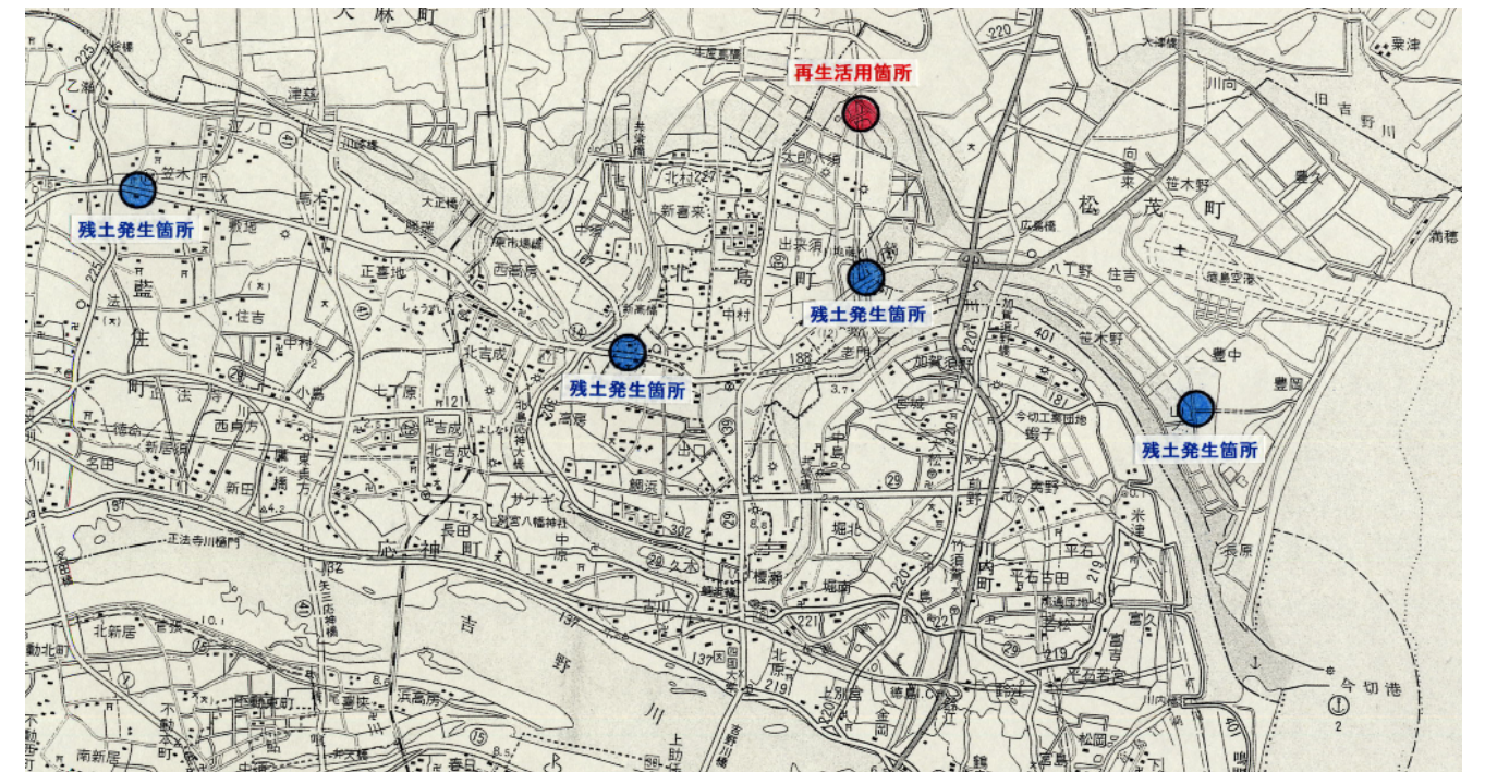
上記4ヶ所の幹線管渠工事から発生するシールド残土を、高速道路の路体の一部として再生利用する。
