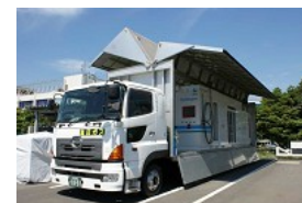
移動式水素ステーション
