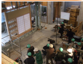
(耐震障子の強度試験)
