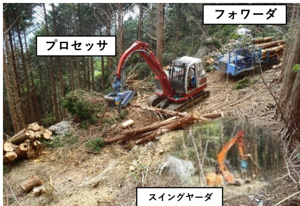
三点セットによる搬出間伐(勝浦町)
