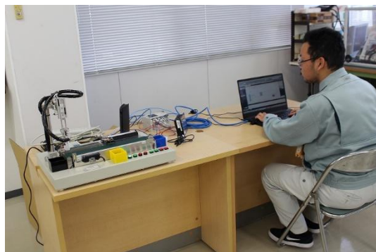
【電気システム科】PLC を用いたロボット制御
