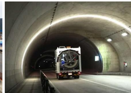
トンネル点検車 ※NETIS登録 (カメラとAIでひび割れを自動検出 作業効率向上に期待)
