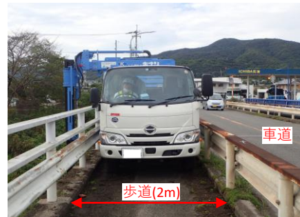
小型橋梁点検車 ※NETIS登録 (通常の点検車と比べ幅員が狭く、 交通規制緩和に期待)
